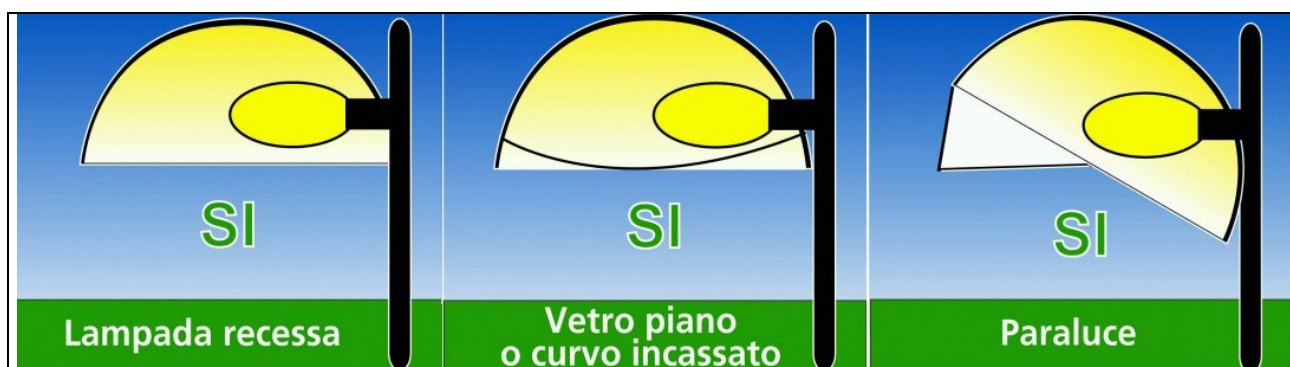
Fig.2 – Apparecchi conformi alla L.r. 17/09.
